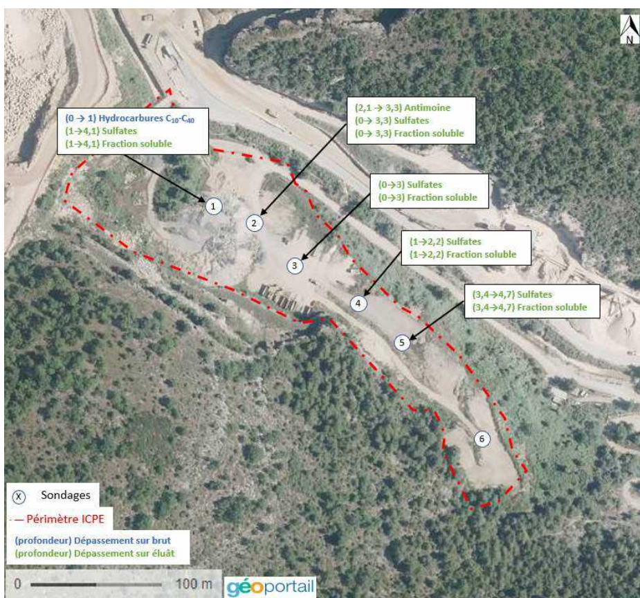
FIGURE 32 : LOCALISATION DES SONDAGES ET DES DEPASSEMENTS DES SEUILS « ISDI »
