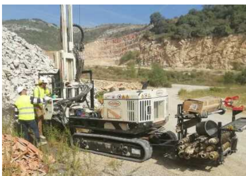
FIGURE 30 : SONDAGE AU CAROTTIER BATTU SOUS GAINÉ (S1)
